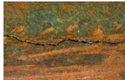
写真(3) 漏洩部の断面
