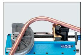
銅管をセットする時、ガイドの先端部分がシューのゼロ点より少し内側に当たるようにセットする。目安はシューのゼロ点よりガイド先端部が15~20mm内側になるようにセットする。
