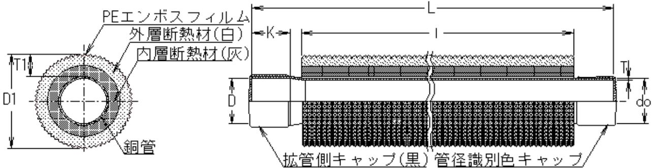
3. 銅管 トーヨーの冷媒用被覆銅管は、NJT銅管(株)製または同等品の、りん脱酸銅継目無管を使用しています。
