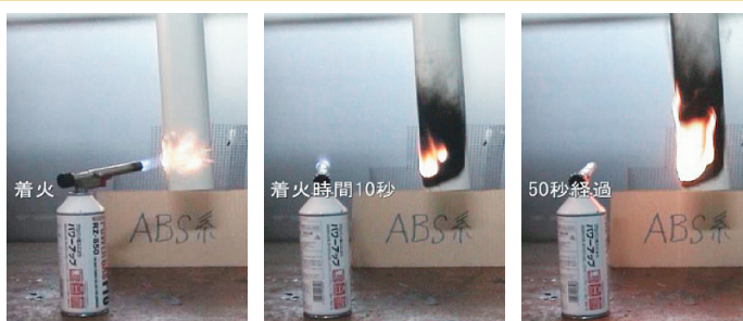
ABS系ダクト 着火 — 10秒後 → 燃焼継続 — 50秒後 → 燃焼継続
